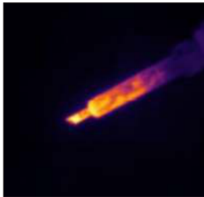
烙铁温度点检
