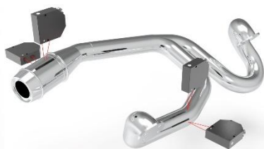
测量消声器的振动
