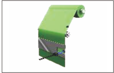
检测料带的不同色标定位点
