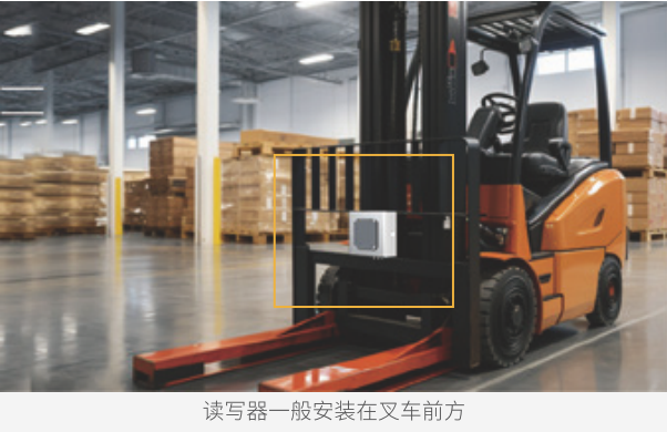
读写器一般安装在叉车前方
