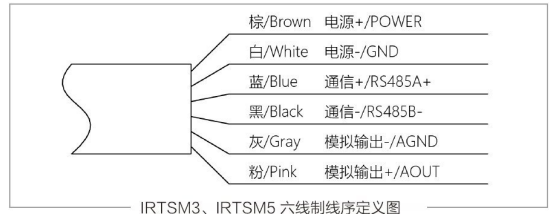
IRTSM3、IRTSM5 六线制线序定义图
